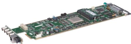
模块化SDI倒换切换器，可用于USF-105AS或USF-212AS/212BS机箱(p.18)。检测两个SDI输入的状态，并可在一路输入有问题的情况下无缝切换到另一路。
